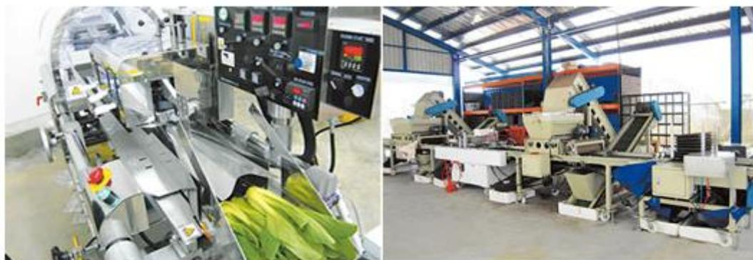
自動包装機（左）や自動種まき機（右）の導入によって作業の効率化を図り、衛生面も配慮されている。
